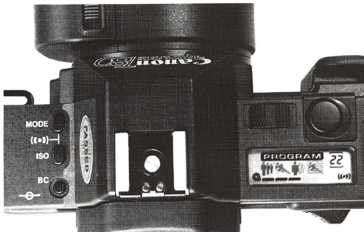
LCD-displayet viser, at filmen er kørt frem, og der er taget 22 billeder, samt at bip-signalet for korrekt skarphedsindstilling er slået til. Bemærk symbolerne for de fem programmer, hvoraf det valgte fremstår tydeligst (her standardprogrammet).
